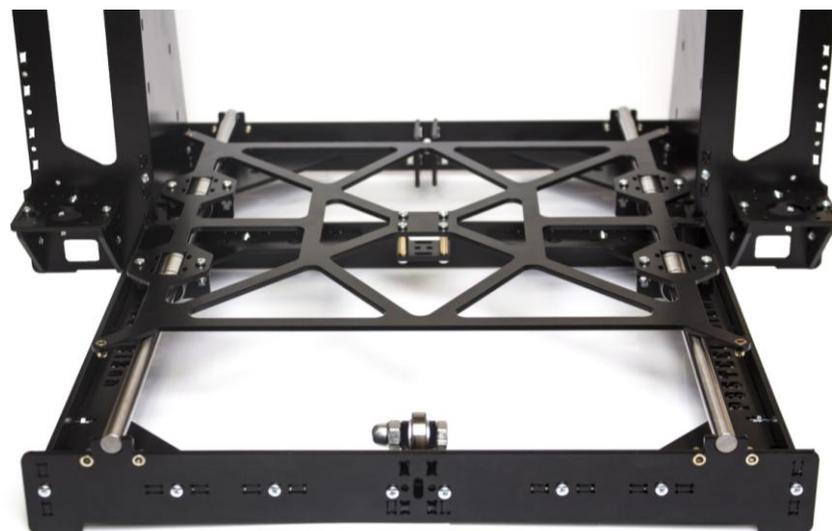
Затем фиксируем валы спереди и сзади прижимными пластинами. Используем для этого винты М3х16. При необходимости можно использовать шайбы для дистанционирования прижимной пластины.
