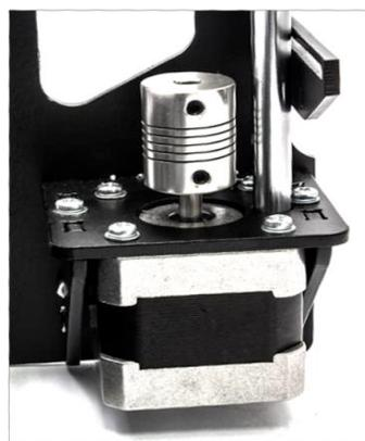
Далее устанавливаем двигатель каретки оси X. Фиксируем двигатель винтами М3х20 с использованием нейлоновых стоек 3х14мм
