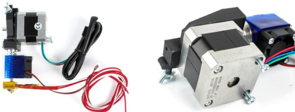
Перед установкой экструдера необходимо удлинить провода для вентилятора охлаждения хотенда. Для этого используем тонкие двужильные провода, места пайки изолируем термоусадкой. Вентилятор будет подключаться напрямую к блоку питания, поэтому отрезайте провод с запасом. Обратите внимание на полярность вентилятора: красный + , черный -. Провода аккуратно убираем в спиральную оплетку по всей длине.
