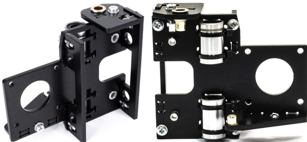
**Каретка для экструдера.** При сборке каретки используем винты M3x12. Подшипники LM10uu вставляем в пазы и фиксируем пластиковыми стяжками, по 2 на подшипник.
