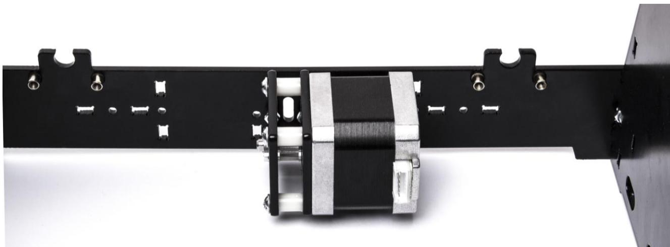
Фиксируем двигатели оси Z винтами М3х8 в левом и правом держателе.
