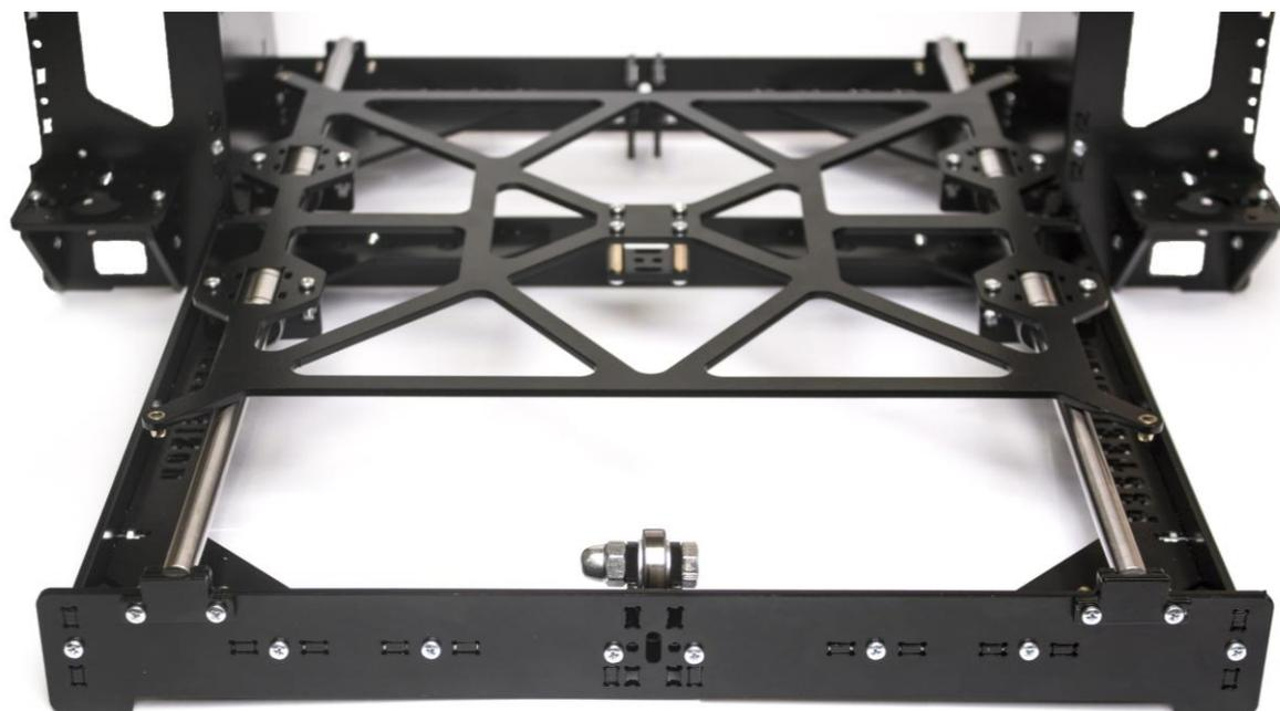
Фиксируем валы со стороны задней стенки
