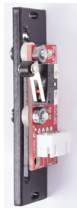
Держатель концевика оси X крепится пластиковыми стяжками к валам (впрыток к правой каретке). Концевик должен включаться при столкновении с кареткой экструдера. Крепим концевик двумя винтами М3х12 (потайные) к держателю. Дистанционируем концевик гайками М3 (либо нейлоновыми стойками 3х9). Концевик должен включаться при столкновении с кареткой экструдера.
