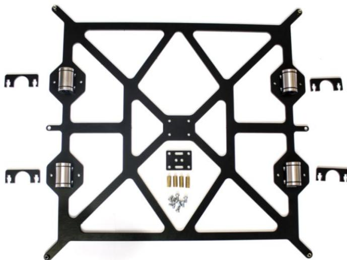
Для крепления фиксатора ремня используем шестигранные стойки и винты M3x8. Сначала вставляем винты M3x8 в каретку, затем накручиваем на них стойки. Пластину для фиксации ремня прикручиваем винтами M3x8 к стойкам.
