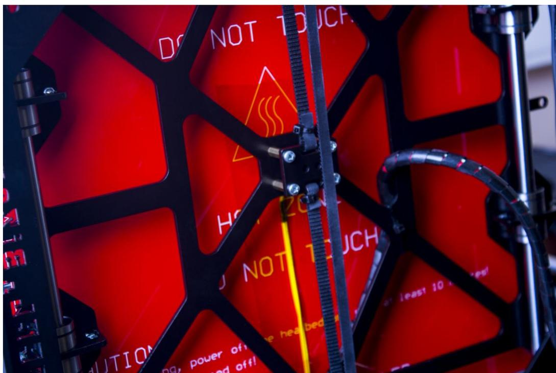
Теперь можно закручивать прижимной винт до необходимого натяжения ремня.
