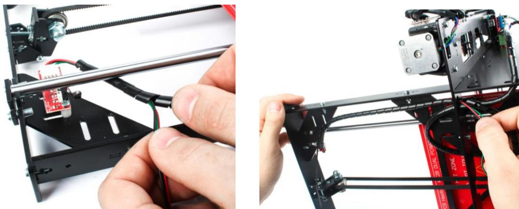
Следует обратить внимания на подключение двигателей оси Z. Двигатели оси Z следует подключить последовательно одним штекером по данной схеме:
