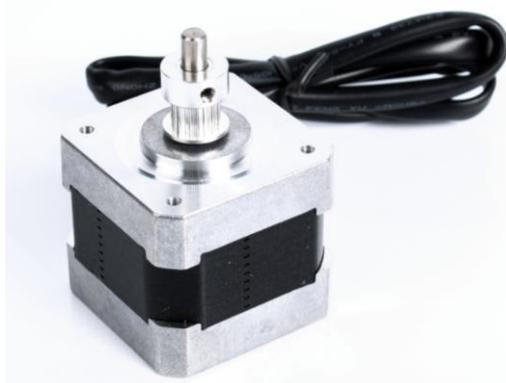
Собираем узел крепления двигателя. Используем два держателя и нейлоновые стойки 9мм, фиксируем винтами М3х20, но до конца не затягиваем
